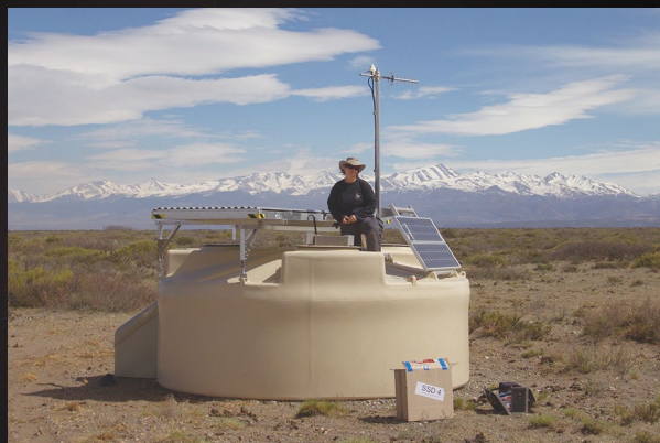
Montaż detektora scyntylacyjnego SSD na jednej ze stacji detektora powierzchniowego Obserwatorium Pierre Auger. Fot.: Współpraca Pierre Auger
